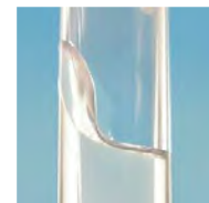
Séparateur acrylique avec amorce de migration (brevet déposé)
