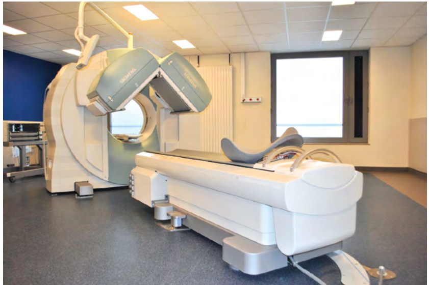
Caméra « hybride » de haute qualité capable de réaliser dans le même temps une scintigraphie et un CT-Scan.
